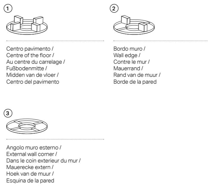
**IT** Le alette dei supporti sono facilmente asportabili allo scopo di ottenere le declinazioni bordo muro, angolo muro esterno ed angolo muro interno.
