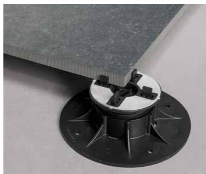
**DE** Die selbstnivellierenden Träger decken einen Bereich zwischen 50 und 75 mm ab und ermöglichen, Gefälle oder und Unebenheiten des Untergrunds bis zu 5% zu kompensieren. Der Einstellungsschlüssel erlaubt es, die Höhe der Träger auch beim fertigen Boden einzustellen.
